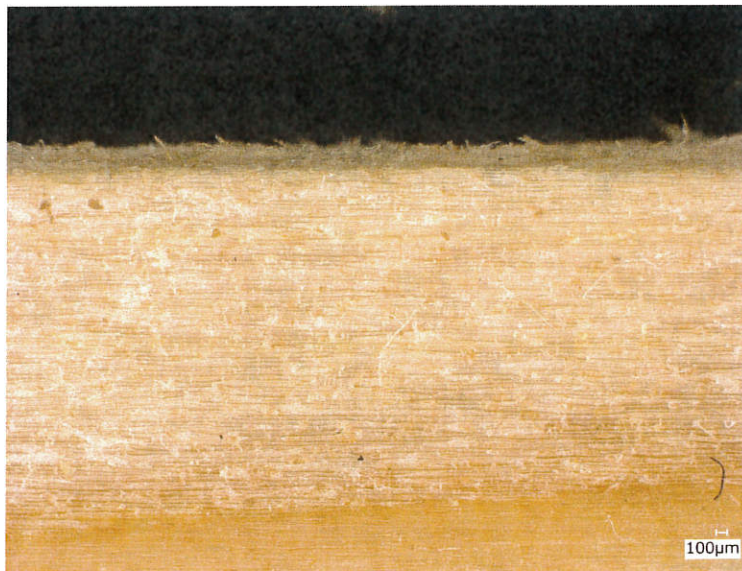
写真 3. 培養 4 週間後のスギ処理腐火止木液処理済の実体顕微鏡像
