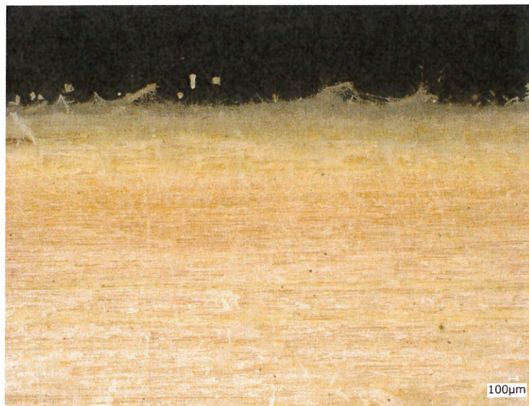
写真 2. 培養 4 週間後のスギ処理無の実体顕微鏡像
